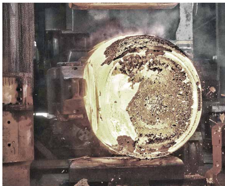
Schmieden eines ESU-Blockes auf einer 30MN-Pressen ▲
